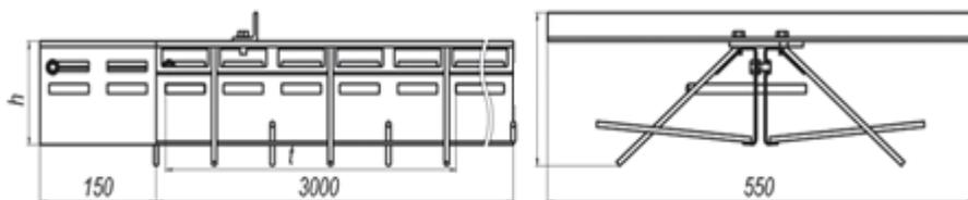
Арматура 1 ремонтного профиля должна быть увязана с армированием бетонного пола. Обеспечивает единство профиля и старого бетонного основания.
